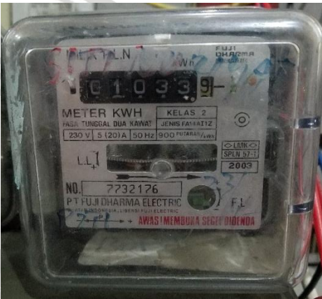
Gambar 4.23 Data pada kWh meter analog 3 sebelum dan setelah dilakukan pembebanan beban fluktuatif.
