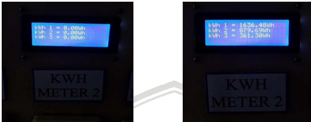
Gambar 4.16 Data pada alat sebelum dan setelah dilakukan pembebanan beban konstan.
