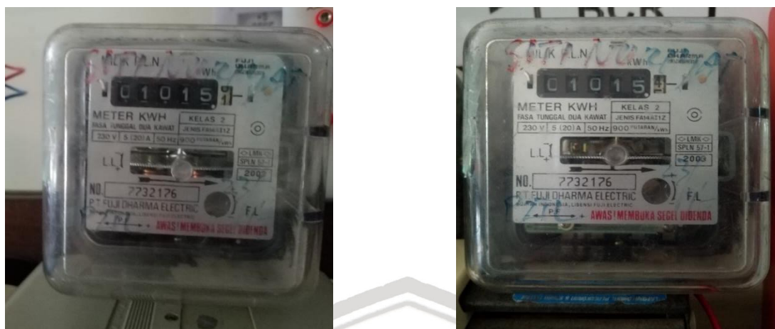
Gambar 4.19 Data pada kWh meter analog 3 sebelum dan setelah dilakukan pembebanan beban konstan.
