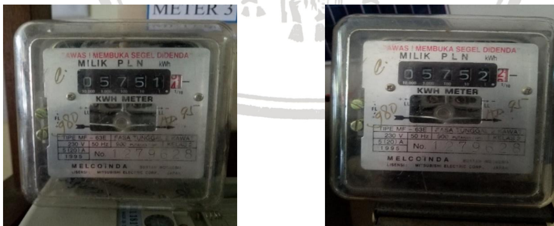
Gambar 4.18 Data pada kWh meter analog 2 sebelum dan setelah dilakukan pembebanan beban konstan.
