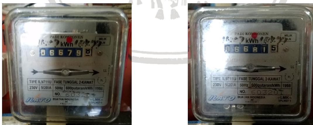
Gambar 4.21 Data pada kWh meter analog 1 sebelum dan setelah dilakukan pembebanan beban fluktuatif.
