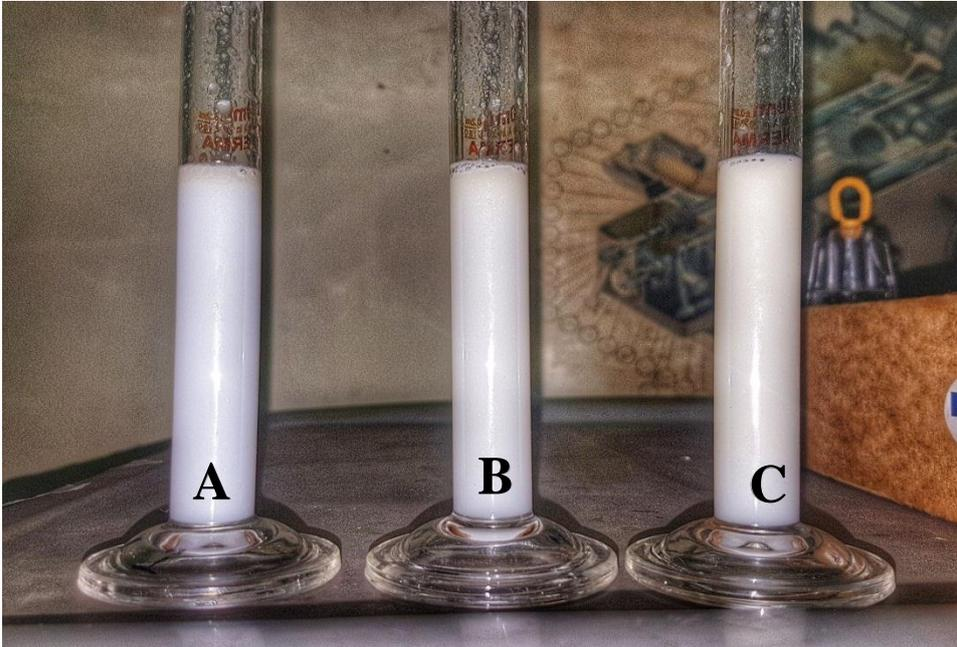
Gambar 4.6 Campuran minyak jarak dengan air sebelum proses pembekuan
