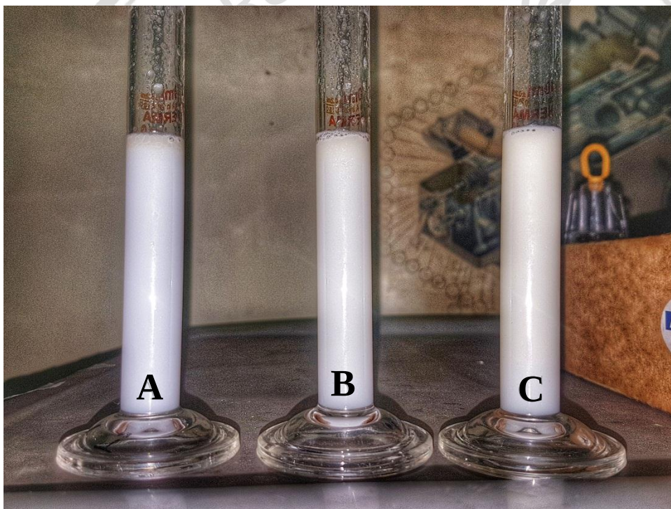
Gambar 4.1 Spesimen phase change material a. 30/70 (M/A), b. 20/80 (M/A), c. 10/90(M/A)
