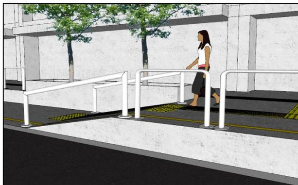
Gambar 4.156 Handrail untuk alat bantu berjalan
