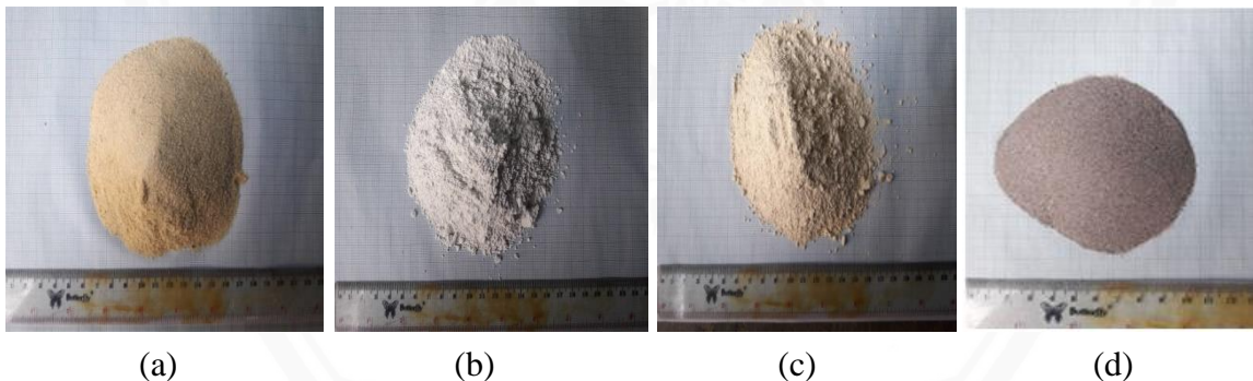
Gambar 2.1 Bahan keramik yang digunakan, (a) feldspar , (b) kaolin, (c) silika, (d) ZrSiO_4
