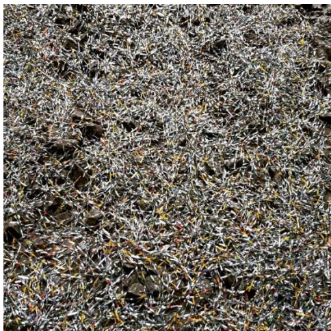
Gambar 4.4 Proses pencampuran serat ke dalam campuran beton
