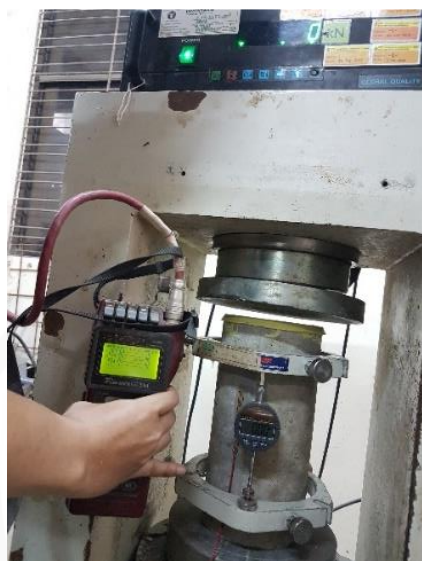
Gambar 4.14 Proses pengujian kuat tekan silinder beton
