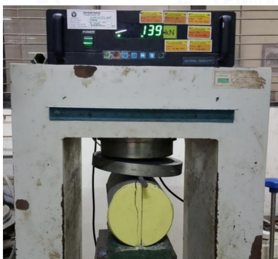
Gambar 4.8 Proses pengujian kuat tarik belah silinder beton
