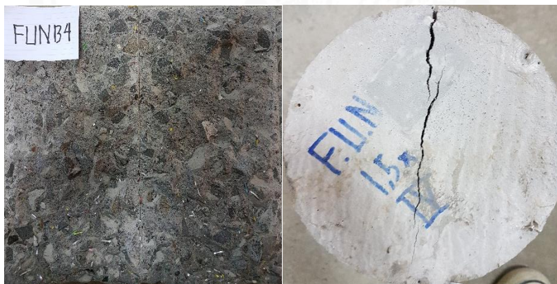
Gambar 4.13 Benda uji beton fiber pilin B setelah proses uji tarik belah
