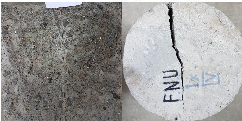
Gambar 4.12 Benda uji beton fiber pilin A setelah proses uji tarik belah
