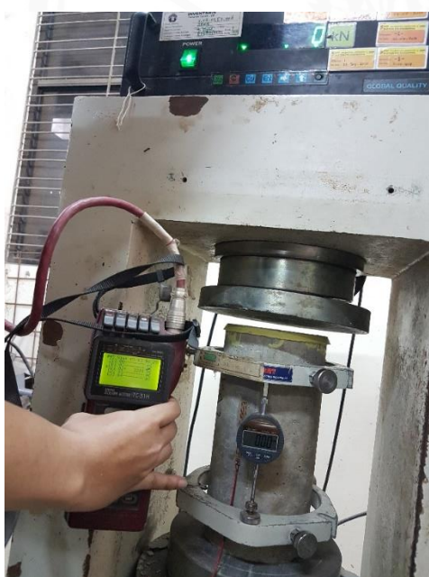
Gambar 4.5 Proses pengujian kuat tekan silinder beton
