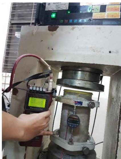
Gambar 4.14 Proses pengujian kuat tekan silinder beton
