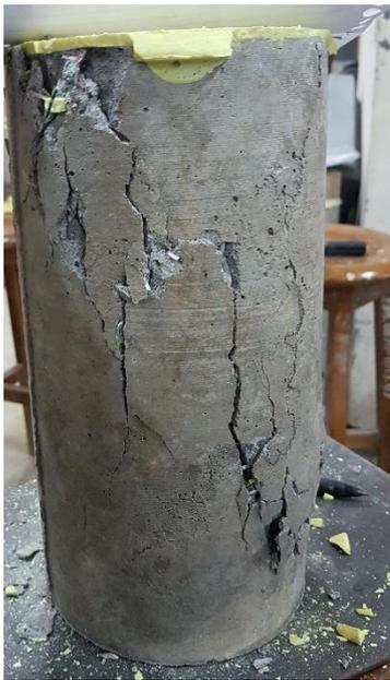
Gambar 4.6 Beton yang sudah di uji kuat tekan
