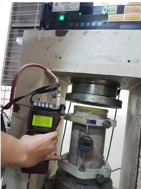
Gambar 4.5 Proses pengujian kuat tekan silinder beton
