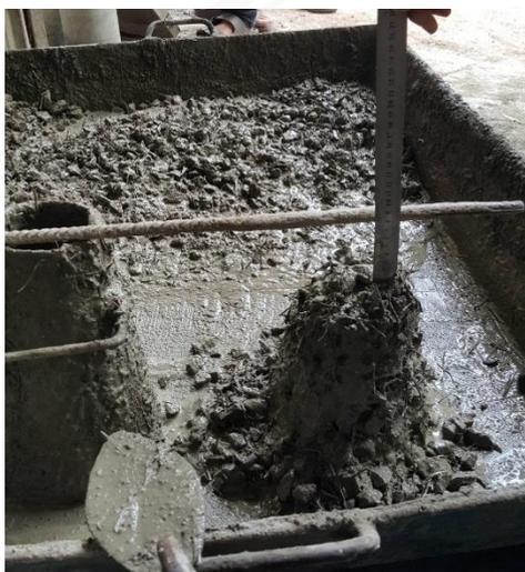
Gambar 4.2 Proses uji *slump*
