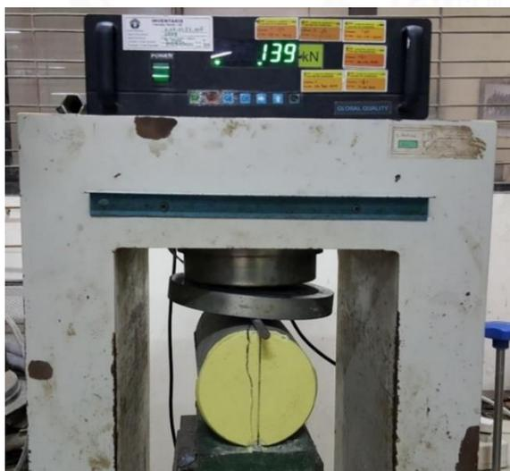
Gambar 4.8 Proses pengujian kuat tarik belah silinder beton
