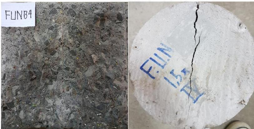
Gambar 4.13 Benda uji beton *fiber* pilin B setelah proses uji tarik belah
