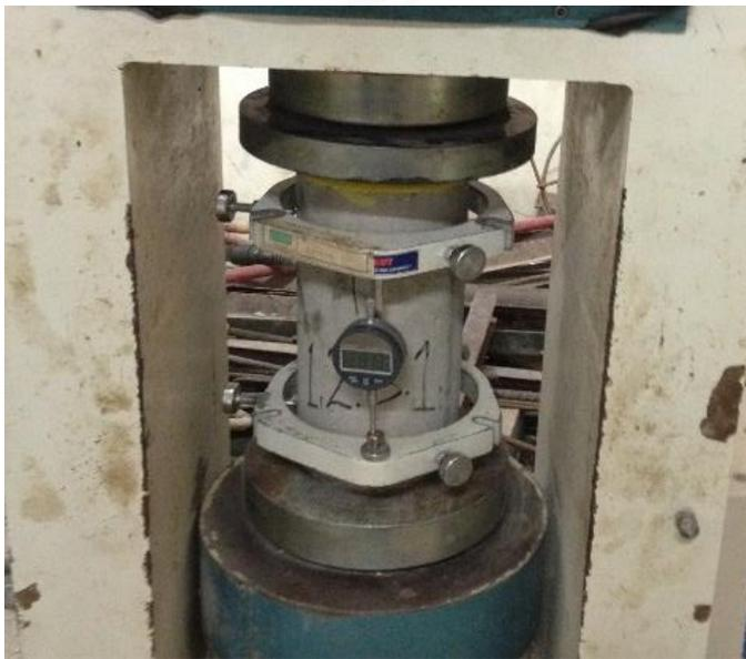
Gambar 2.7 Uji modulus elastisitas menggunakan *extensometer*
