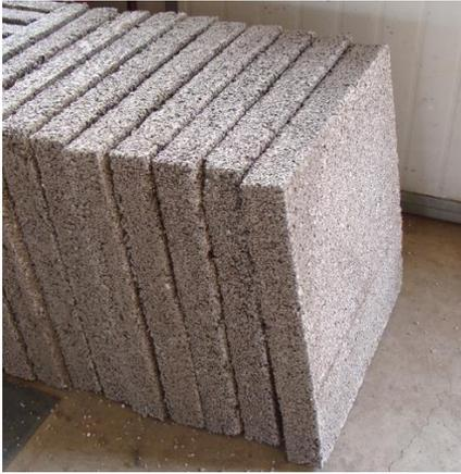
*Gambar. 2.2* Contoh Beton Porous Sebagai Plat Beton
