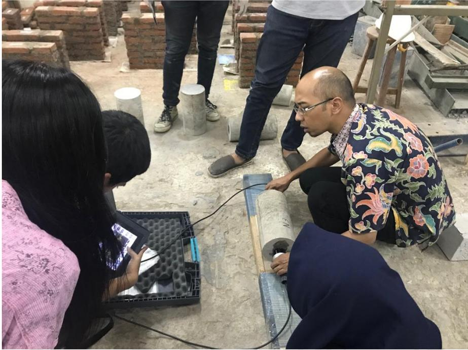
Proses Pengujian Alat UPV pada Beton Fiber
