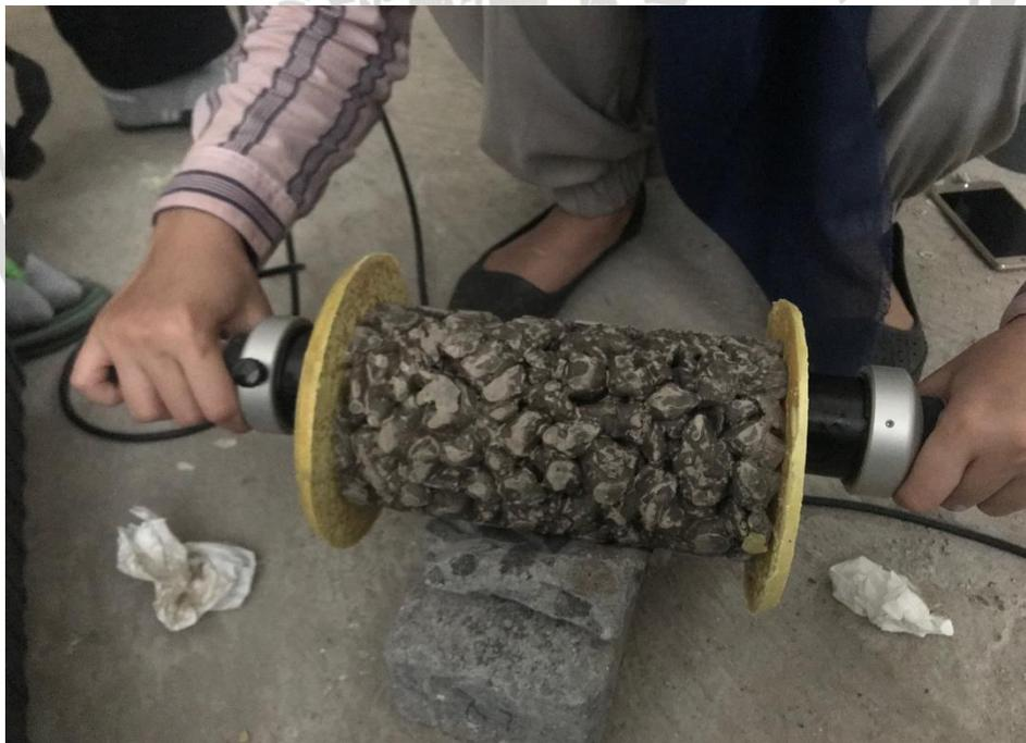
Proses Pengujian Alat UPV pada Beton Porous
