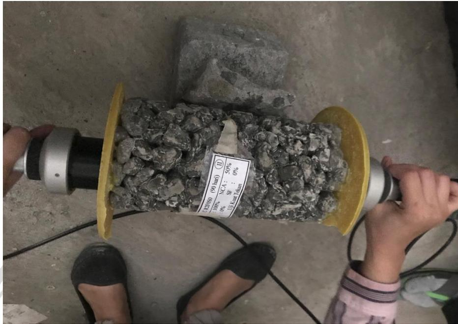
Proses Pengujian Alat UPV pada Beton Porous
