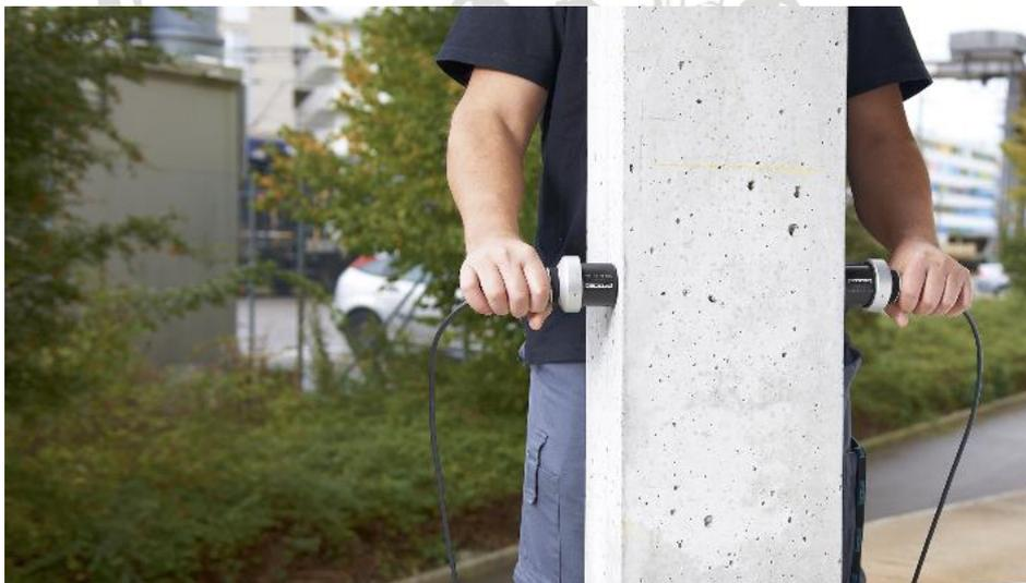
Gambar 2.12 Contoh Pengujian UPV Dengan Metode *Direct*
