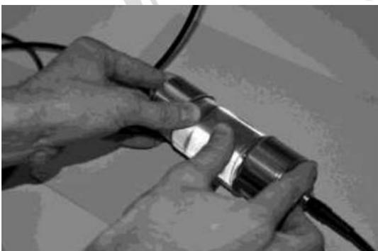
Gambar 3.3 Proses Kalibrasi Awal Alat Uji UPV.
