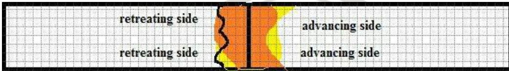
Gambar 4.3 Visualisasi advancing side dan retreating side pada putaran tool yang searah
