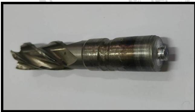
Gambar 3.6 Tool FSW dengan pin flat-end cylindrical
