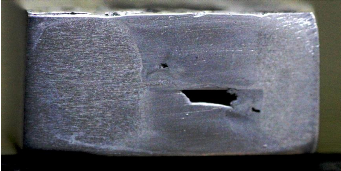
Gambar 4.13 Makrostruktur Hasil Sambungan Las Pada Variasi Panjang Pin 3,5 mm searah
