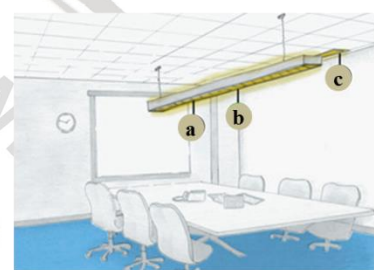
Keterangan: a. Pencahayaan tugas: direct-indirect b. Pencahayaan layar: direct c. Pencahayaan dinding: wallwasher
