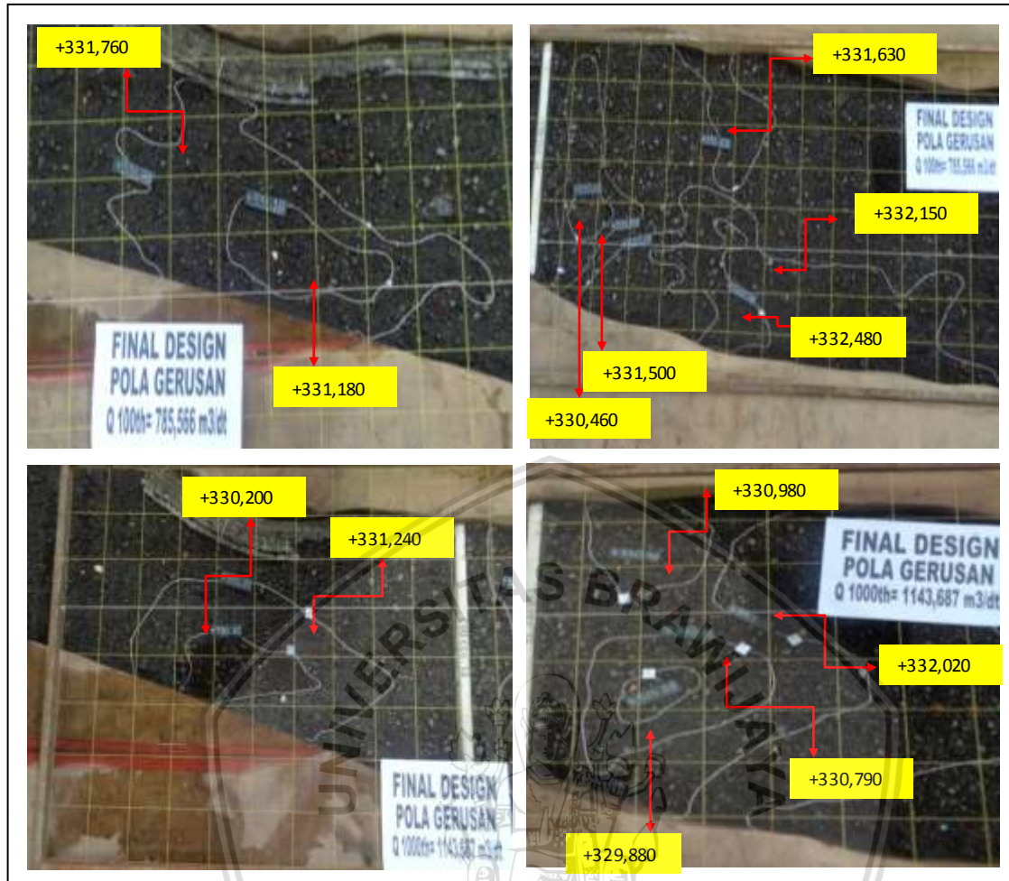
Gambar 4.40 Pola Gerusan dengan adanya bangunan alternatif 2 Sumber: Dokumentasi (2017).
