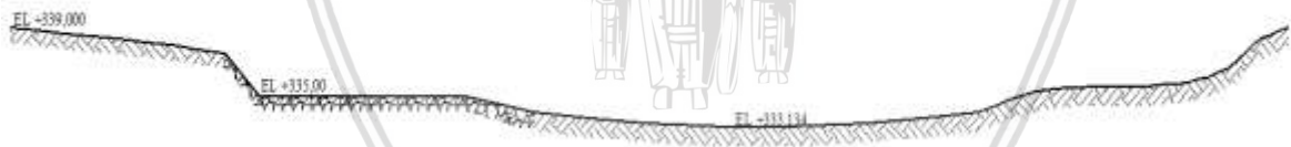
Gambar 4.3 Penampang Sungai untuk Perhitungan Tail Water Level
