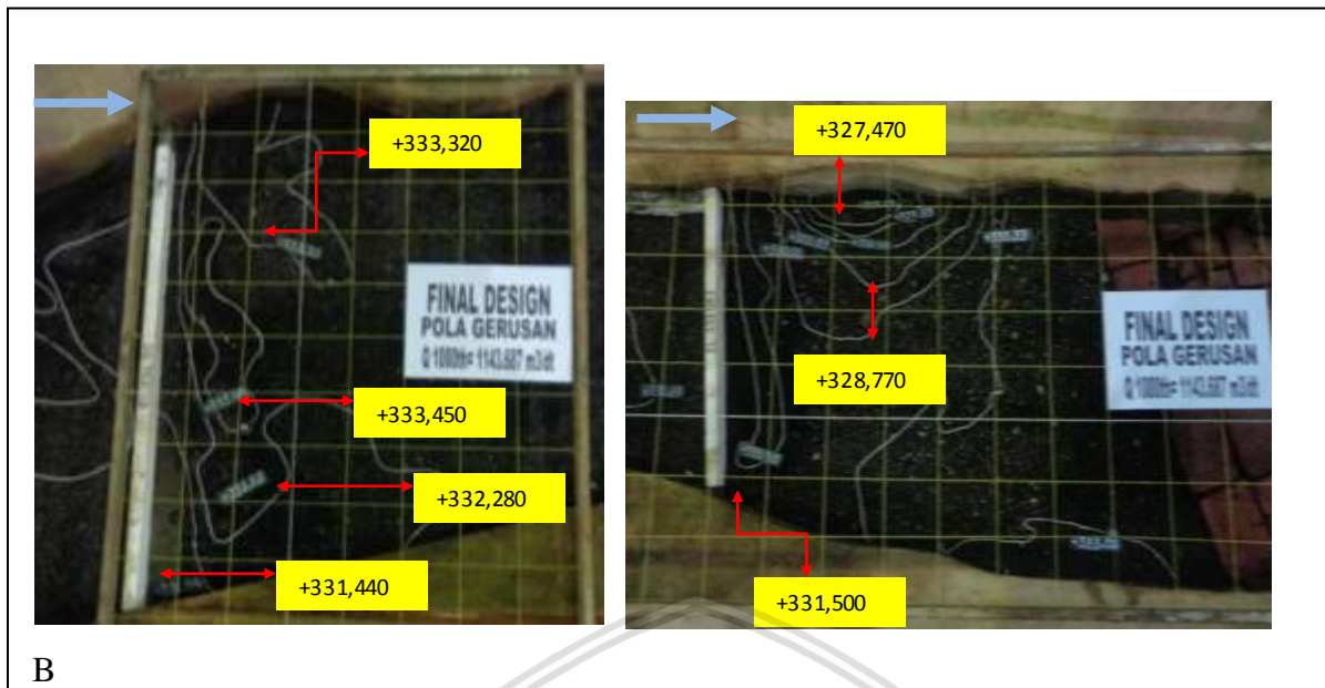
Gambar 4.36 Pola Gerusan dengan adanya bangunan alternatif 1 Sumber: Dokumentasi (2017)
