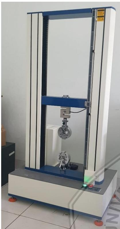
Gambar 3.6 Mesin uji tarik
