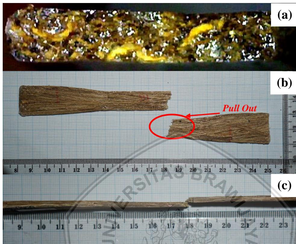
Gambar 4.7 Permukaan patahan komposit serat perendaman NaOH 5% (a) tampak patahan (b) tampak atas (c) tampak samping
