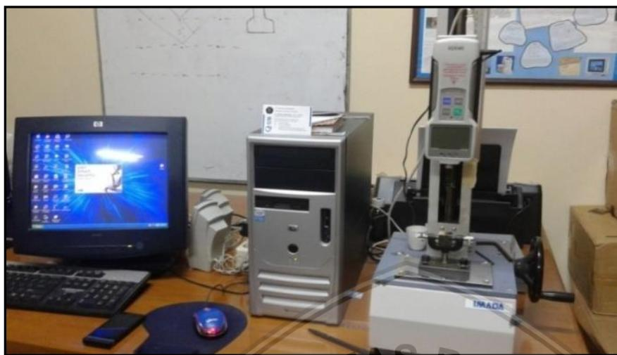
Gambar 3.4 Mesin uji tarik serat tunggal
