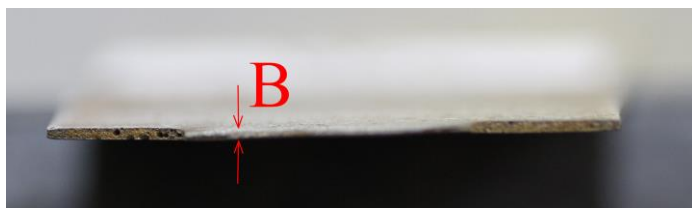
Gambar 4.4 Tebal dari spesimen Uji SCC (B)
