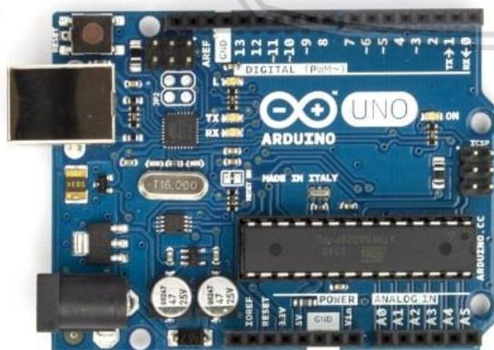
Gambar 2.1 Arduino Uno dan Komponennya
