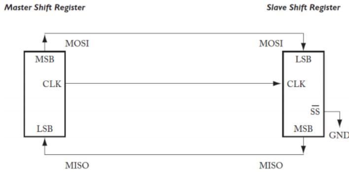
Gambar 2.7. Blok Diagram antarmuka SPI
