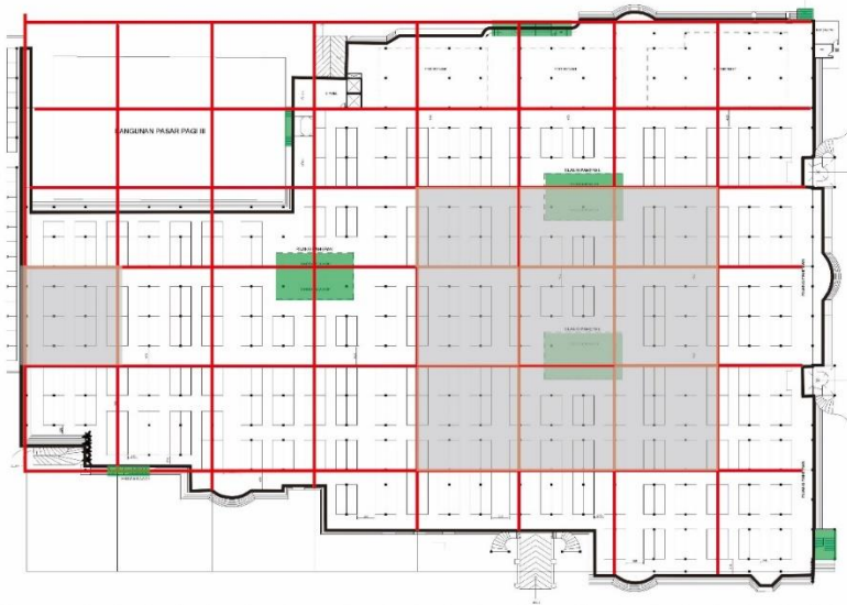
Gambar 4. 48 Jarak tempuh pintu keluar lantai 1 tahap II
