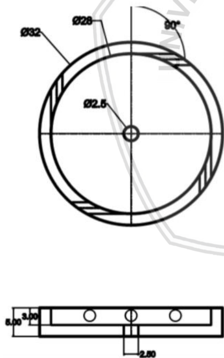
Gambar 3.1 Tangential circular disk combustor dengan 4 inlet
