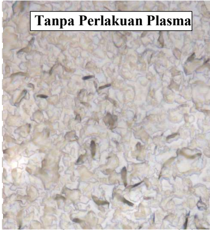
Gambar 4.9 Perbedaan morfologi permukaan polistirena pelarut xylene sebelum dan sesudah perlakuan plasma
