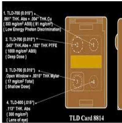
Gambar 2.4 Dosimeter standar TLD Harshaw yang terdiri dari empat elemen (PNNL, 2010).
