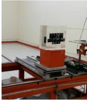
Gambar 3.1 Penyinaran keseragaman TLD Harshaw dengan model fisis berupa water solid fantom PMMA.
