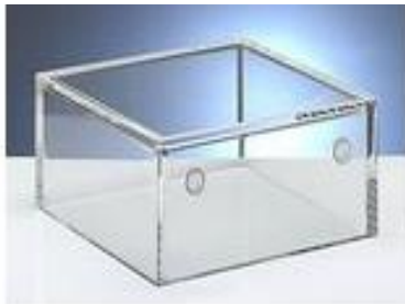
Gambar 2.8 Water solid fantom PMMA untuk kalibrasi personal dosimeter (IAEA, 2000).
