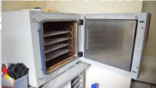
Gambar 3.1 Proses annealing dengan menggunakan oven sebelum penyinaran
