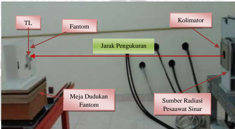
Gambar 3.8 Penyinaran TLD pada fantom dengan sumber radiasi pesawat sinar X
