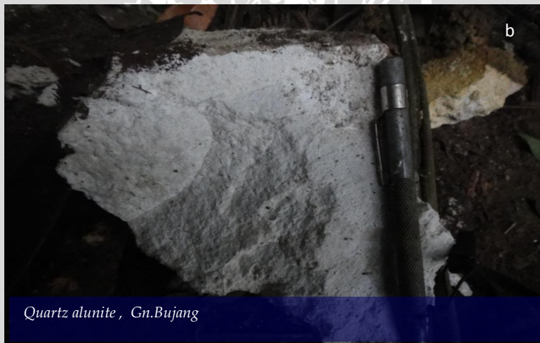
Gambar 4.3 Foto handspeciment di atas memperlihatkan ciri-ciri lithocap yang biasanya berasosiasi dengan endapan HS. a. Foto Breksi vulkanik hydrothermal mineralisasi vuggy quartz pada lereng Bujang. Vq: Vuggy quartz ; Pyr: Pyrite ; Hem: Hematite ; Jar: Jarosite ; b. Tuf Kristal, alterasi advance argilic berupa quartz alunite produk steam heated .
