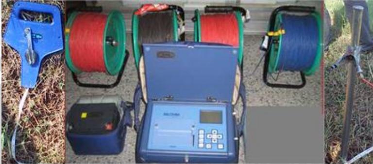
**Gambar 3.2 Peralatan Akuisisi Data Geolistrik**
