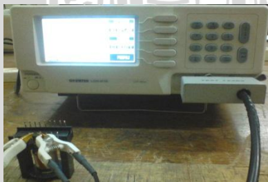
Gambar 3.14. Pengukuran nilai induktansi Trafo dengan LCR meter
