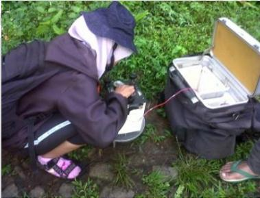
**Gambar L1.3** Mencatat nilai pembacaan gravitometer
