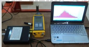
**Gambar L.4.8** Rangkaian adaptor dan komputer (pendukung MCA)
