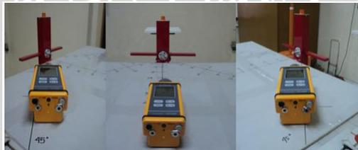
Gambar 3.12 Pengukuran dengan menggunakan detektor atomtex AT 1103 M
