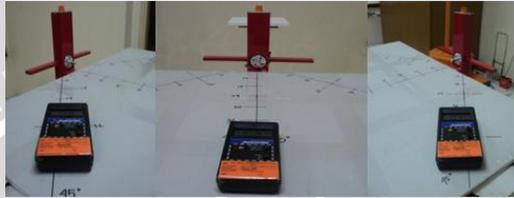
Gambar 3.14. Pengukuran dengan menggunakan detektor Inspector 3092
