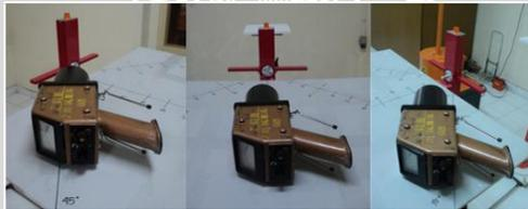
Gambar 3.13 Pengukuran dengan menggunakan detektor Babyline 61A
