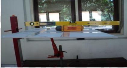
Gambar 3.11 Pengaturan posisi detektor agar tegak lurus dengan menggunakan waterpass
