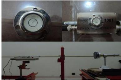
Gambar 3.15 Pengaturan detektor dengan waterpass dan tegak lurus dengan pusat sumber
