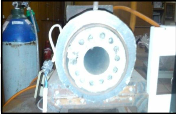
Gambar penampang reaktor redoks
