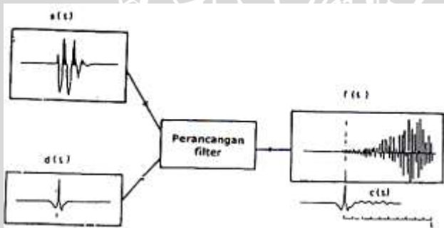
Gambar 2. 13 Sinyal input s(t) , output yang diinginkan d(t) dan bentuk filter Wiener f(t) yang cukup panjang. Output yang sebenarnya ditampilkan di bawah f(t) (Munadi, 2002)
