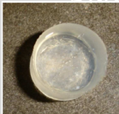
Gambar 2.4: Bentuk fisik silika xerogel [10]
