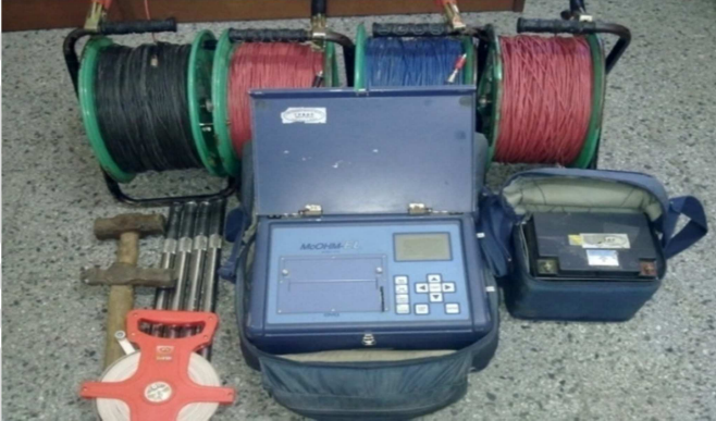
Gambar 3.2 Peralatan pengambilan data geolistrik resistivitas
