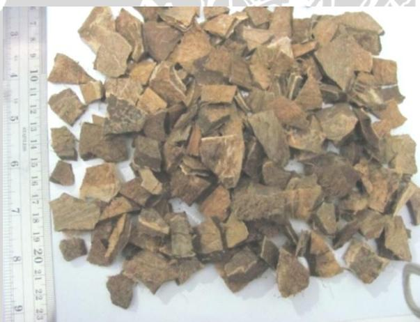
**Gambar 3.4** Sampel tempurung kelapa setelah dibersihkan
