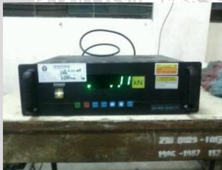
**Gambar 3.13** Pengontrol gaya tekan mesin *press*
