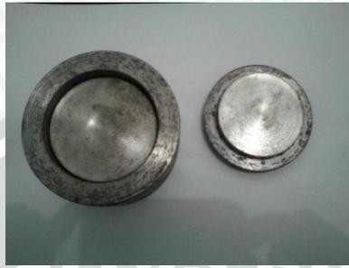
**Gambar 3.11** Cetakan pellet (matras karbon)
