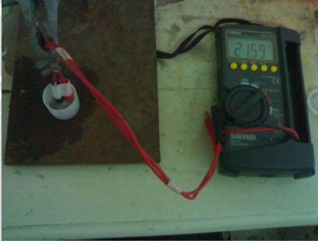
**Gambar F.1** Rangkaian alat biosensor konduktometri organofosfat
