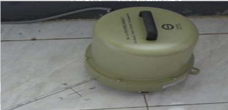
Gambar 3.1. Sensor seismograph SP 3 komponen
