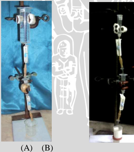
Gambar 3.1: Rangkaian alat ekstraksi fasa padat (A) Proses adsorpsi; (B) Proses elusi
