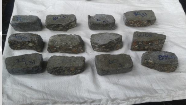
Gambar 3.6 Sampel uji dalam keadaan jenuh
