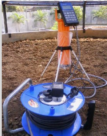
Gambar B6. Detektor NaI(Tl) ATOMTEC
