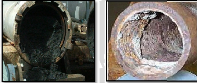
Gambar 2.7 Sludge dan scale di dalam pipa produksi (sumber : Bunawas, 2005)
