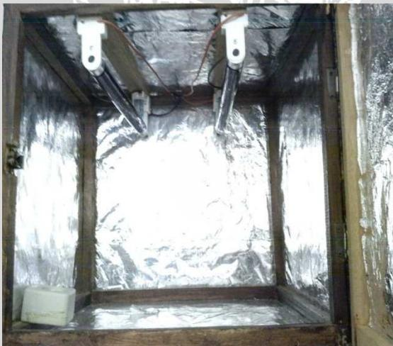
Gambar L.8 Reaktor untuk Uji Fotokatalitik (Bagian Dalam)
