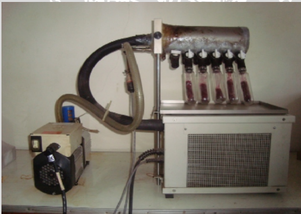
Gambar L.2. Ekstraksi kering beku ekstrak bunga jengger ayam pada suhu -50^{\circ}\text{C} menggunakan alat Freeze Drier
