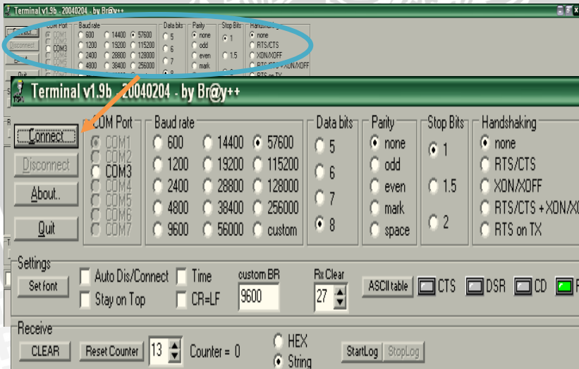
Gambar 4.3 Setting serial pada Software Terminal
