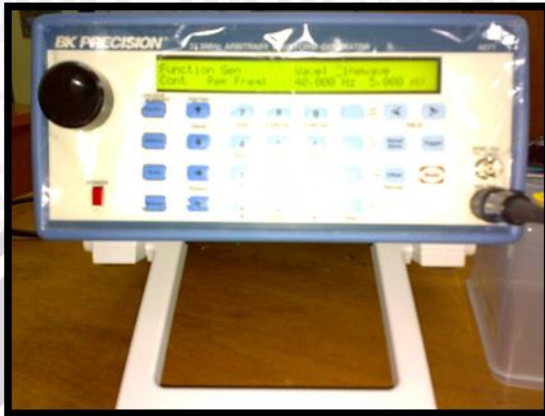
Gambar 13 sinyal generator dengan output frekuensi 40kHz
