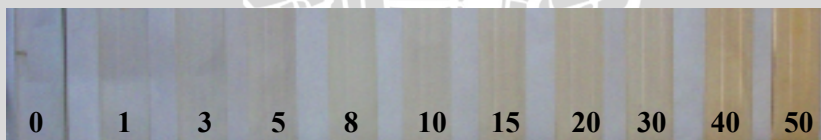
Gambar 4.4 Komparator Besi(III) tiosianat dengan variasi konsentrasi (dari kiri ke kanan) : 0,1, 3, 5, 8, 10, 15, 20, 30, 40, 50 ppm
