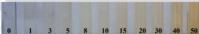
Gambar L.4.3.2 Komparator kolorimetri dengan berbagai konsentrasi sianida
