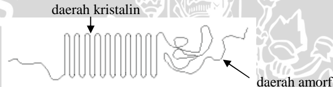
Gambar 2.3. Struktur Polimer Semikristalin
