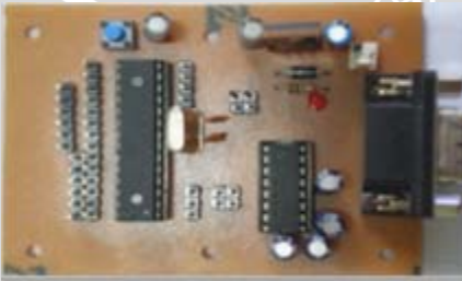
Rangkaian Mikrokontroler dengan RS 232 converter
