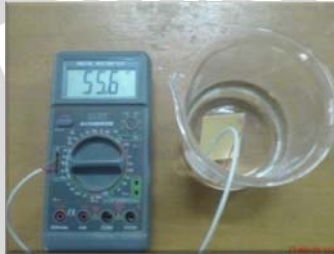
Gambar 3.9 Pengujian nilai kapasitansi sensor kapasitif
