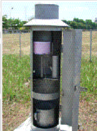
Gambar 2.1 Alat Pengukur Curah Hujan Sumber : Badan Meteorologi Geofisika Malang
