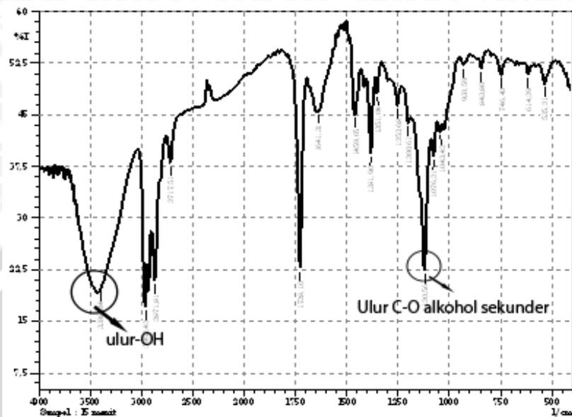
Gambar 4.6. Spektra IR dari 4-metil-5-nonanol Hasil Sintesis
