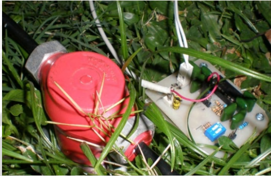
Gambar 4.9 Sensor dan geophone pada kondisi lapangan
