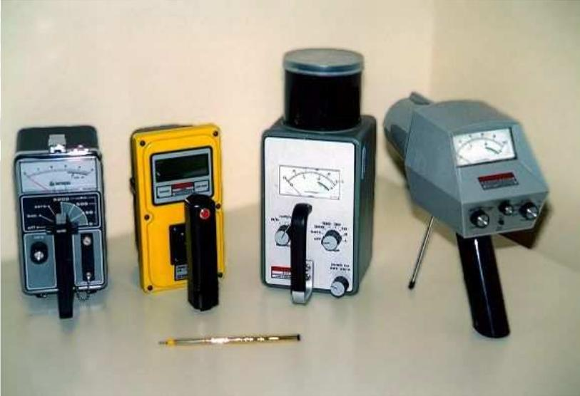
**Gambar 2.9** Macam–macam detektor radiasi
