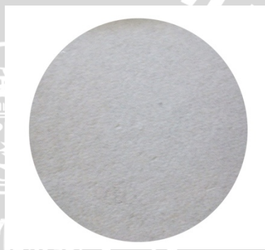
Membran 4 Ukuran Butiran 0,14 mm
