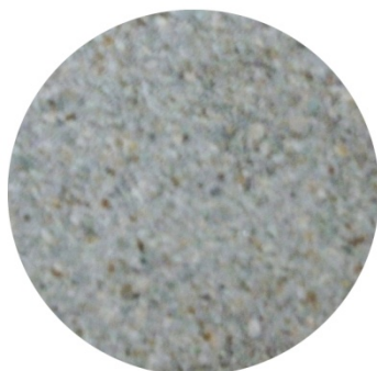
Membran 1 Ukuran Butiran 0,33 mm
