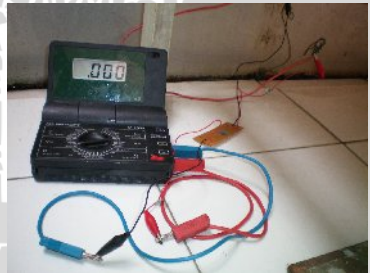
12. Pemasangan I-V converter pada proses pembaluran
