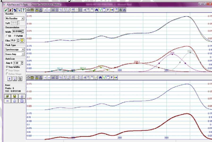
**Gambar 3.13** Salah satu contoh tampilan perkiraan nilai puncak spektrum penyerapan inframerah yang ditentukan dengan metode *deconvolution*.
