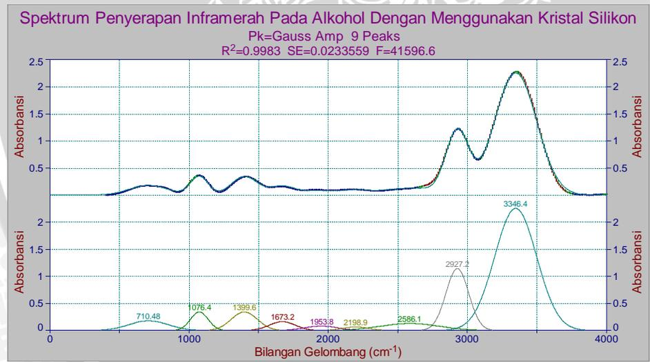
**Gambar 4.2** Spektrum penyerapan inframerah pada alkohol yang dideteksi dengan menggunakan kristal silikon setelah dilakukan pengaturan *baseline* dan *di-smoothing*.
