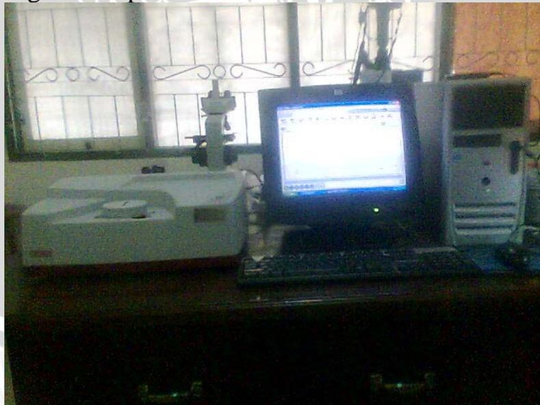
**Gambar 3.4** Mesin FT-IR (Nicolet IR200) yang dihubungkan ke seperangkat komputer.
