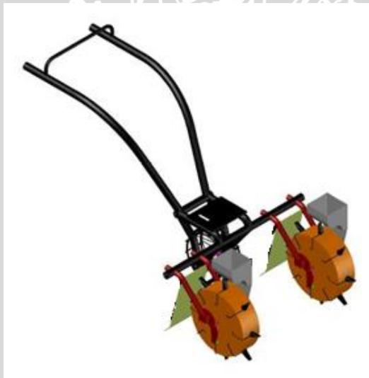
**Gambar 3.1. Gambar Teknik Desain Mesin Penanam Benih Jagung**
