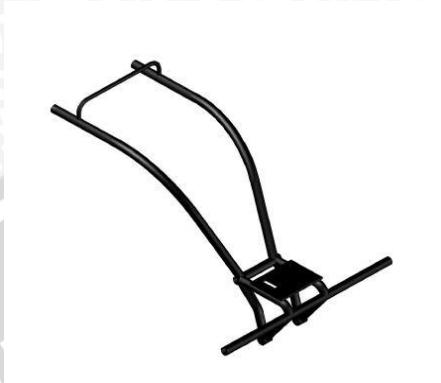
**Gambar 3.2.** Gambar Teknik Desain Kerangka Mesin Penanam Benih Jagung
